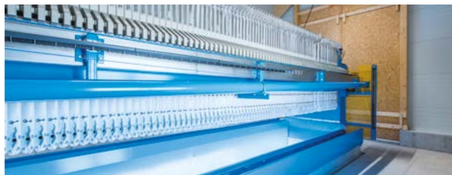
Simultanes Kuchen-Lösen mit Plattenverlegung
