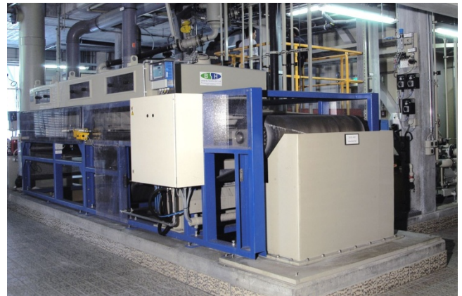
Abbildung 7: Flugaschewäsche in der KVA Trimmis.
