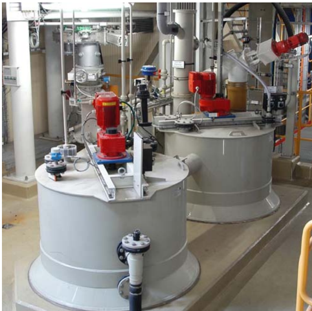
Abbildung 6: Saure Flugascheextraktion in der KVA Trimmis.
